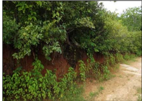
Foto 20 - Solo argilo-arenoso com espessura de 2 a 3m, passível de ser utilizado como material de empréstimo (Ponto 35 UTM-352949/9530016).
