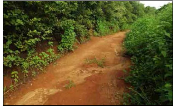
Foto 26 - Solo vermelho com potencial para servir de material de empréstimo (Ponto 35).
